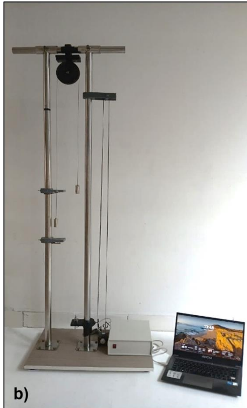
Gambar 3. Peralatan eksperimen berbasis IoT: a) percobaan benda jatuh bebas b) percobaan pesawat Atwood
